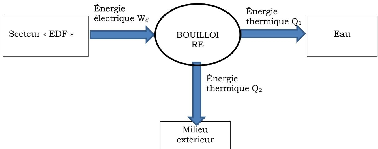
Le rendement est défini par  $\eta = \frac{E_{\text{utile}}}{E_{\text{dépensée}}}$
